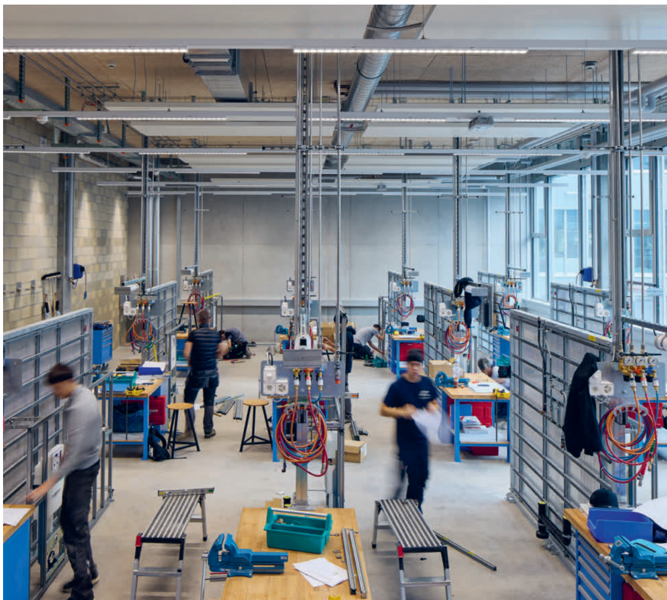
Der Campus Le Vivier vereint zahlreiche Berufsbilder unter einem Dach. In der Werkstatt von Suissetec Freiburg bauen lernende Sanitärinstallateure gerade ein Vorwandsystem auf. (Bilder: ss)
